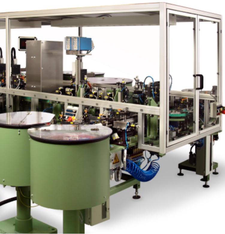
gefertigten Montageautomaten für Elektronikbausteine
